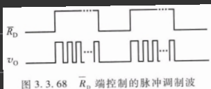
图 3.3.68 \bar{R}_D 端控制的脉冲调制波
